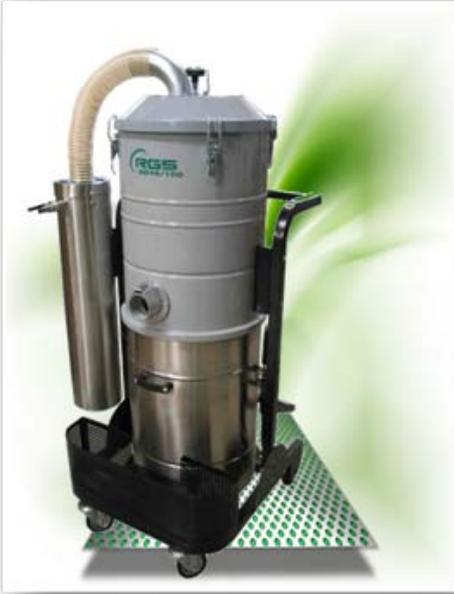
Die Druckluftsauger der Reihe "AD" sind die ideale Lösung, wenn der elektrische Strom nicht vorhanden oder verboten ist. Sie sind mit Druckluft betrieben und dort sind daher keine elektrischen Bauteile und keine bewegenden Teile sind dort nicht zu sehen. Sie können in der ATEX Zonen 21 und 20 innen verwendet werden. Alle Modelle sind serienmäßig so ausgerüstet:
